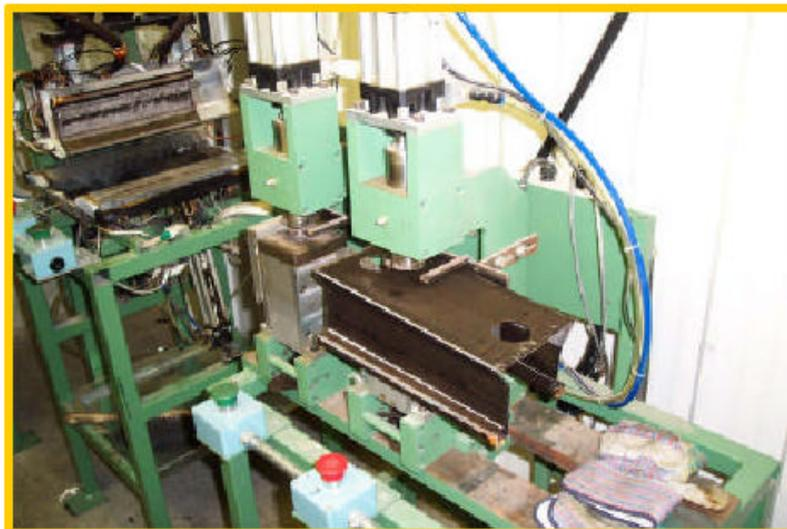
**図 6 : 外殻の底部ドレンホールの打ち抜き**
